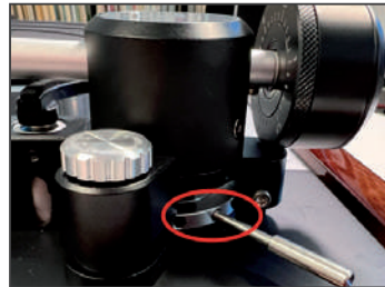
Fig. 14 Verstellen der Armhöhe mittels Werkzeug.
