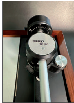
III. 8 Bloc support, contrepoids installé avec graduation pour réglage adhérence et anti-écrasement.
