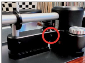
Ill. 15 Réglage en hauteur du lève-bras
